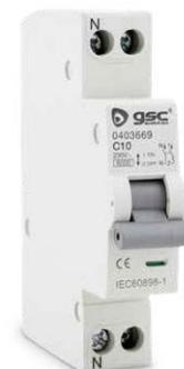
**!** Rango de tensión  $U_n$  (VAC): 230/400. Poder de corte  $I_{cn}$  (KA): 6. Curva de disparo: C. Grado de protección: IP20, con conductores conectados. Nº de maniobras eléctricas: 4.000. Capacidad conexión cable: 0.75-16mm (cable flexible) / 0.75-16mm (cable rígido). Ideal para instalaciones residenciales y terciarias. Protege la instalación contra cortocircuitos y sobrecargas. Ancho de 18mm, indicado para instalaciones con falta de espacio en el cuadro de maniobra.
