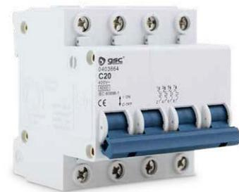
**!** Rango de tensión  $U_n$  (VAC): 230/400. Tensión de aislamiento: (VAC): 500. Poder de corte  $I_{cn}$  (KA): 6. Curva de disparo: C. Grado de protección: IP20, con conductores conectados. Nº de maniobras eléctricas: 4.000. Capacidad conexión cable: 0.75-25mm (cable flexible) / 0.75-35mm (cable rígido). Ideal para instalaciones residenciales y terciarias. Protege la instalación contra cortocircuitos y sobrecargas, su uso también es apto para control y maniobra.
