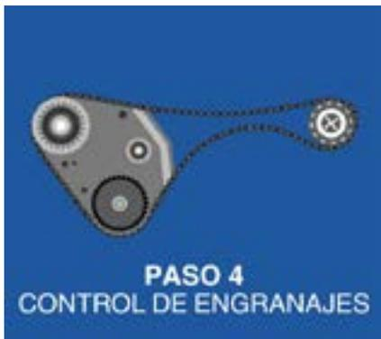
A día de hoy, son muy pocos los ventiladores con engranajes, no obstante, si tu ventilador tiene, debes controlarlos para evitar daños. Estos no deben tener ningún desgaste, estar apretados y debemos lubricarlos.
