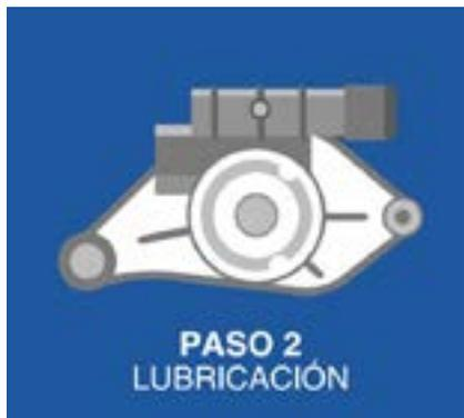
Lubricar el motor y los ejes contribuye a prolongar la vida útil de cada pieza, además de eliminar futuros ruidos. Los ventiladores suelen tener agujeros por donde podemos insertar el spray, si no, se puede hacer con brocha.
