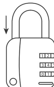
Volver a girar y levantar el gancho hacia el otro lado. Girar los diales (sin coincidir con la combinación seleccionada), girar el gancho y presionar hacia abajo.
