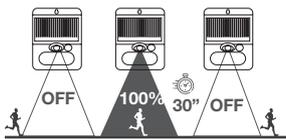
**Modo A.** Luz apagada, cuando detecta presencia se enciende al 100%, si no detecta presencia a los 30 segundos la luz se apaga automáticamente.
