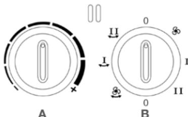
Conectar la fuente de alimentación y la luz indicadora se encenderá; girar la rueda (B) para elegir la función deseada.
