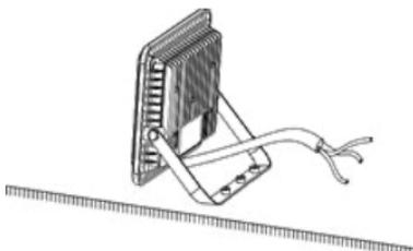
3. Se puede instalar el proyector LED en el suelo, pared o techo.
